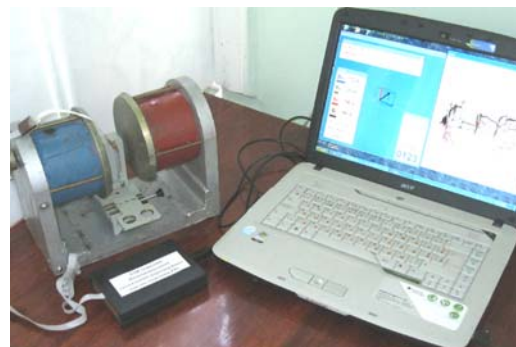
Рис. 11. Стенд для дослідження характеристик РХС та відладки сенсорних пристроїв на їх основі
